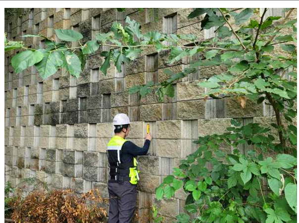
경사계를 이용한 경사도 측정
